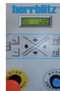
这个小而紧凑的电器箱可以安装于所有型号并允许在一个冲压周期内重复进给多次。进给器将在进给冲压程序设定数量后控制压力机降速。
